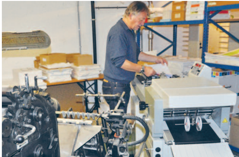
Links der alte Tigel (er und Martin Schneider sind Jahrgangskollegen), rechts die neue Falzmaschine und dazwischen ein Stapel Papier der zur Verarbeitung bestimmt ist.
